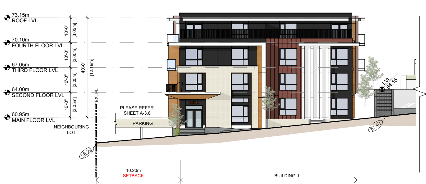
1 SOUTH ELEVATION (BUILDING-1) N.T.S
