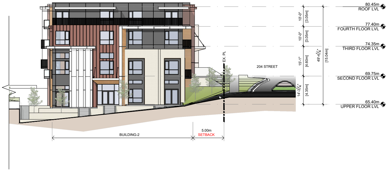
2 SOUTH ELEVATION (BUILDING-2) N.T.S
