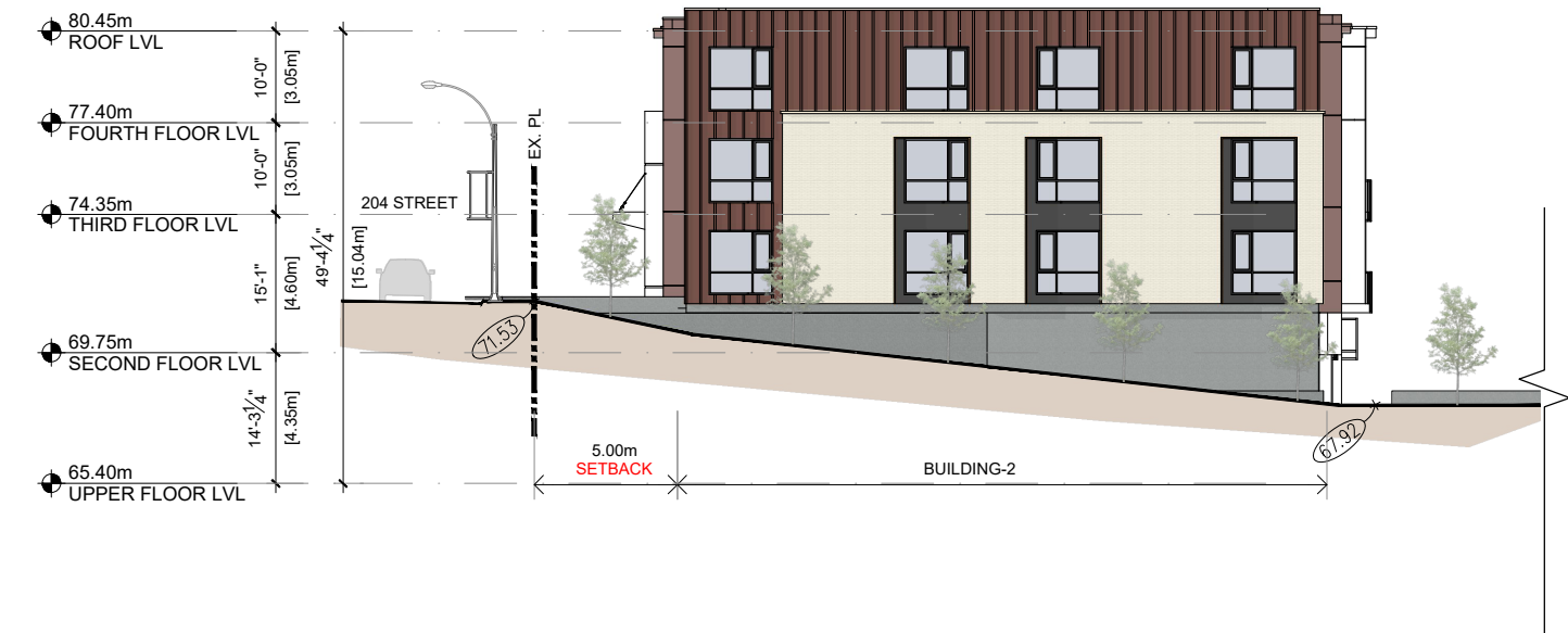
3 NORTH ELEVATION (BUILDING-2) N.T.S
