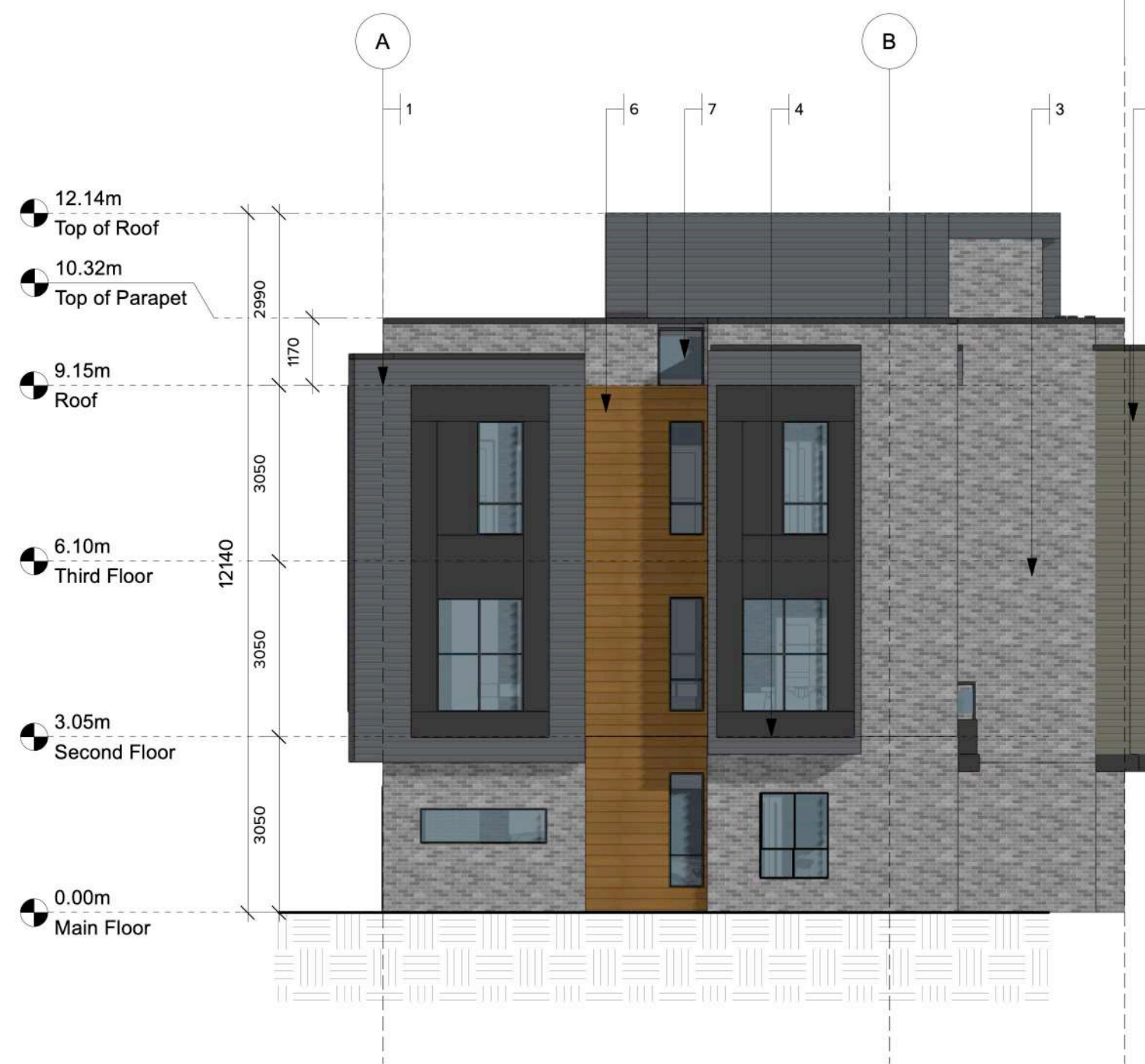
4 WEST ELEVATION - (BUILDING 5) Scale: 1:100
