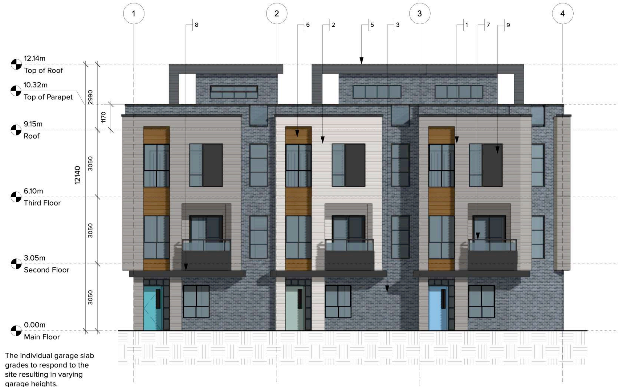
1 WEST ELEVATION - (BUILDING 1) Scale: 1:100
