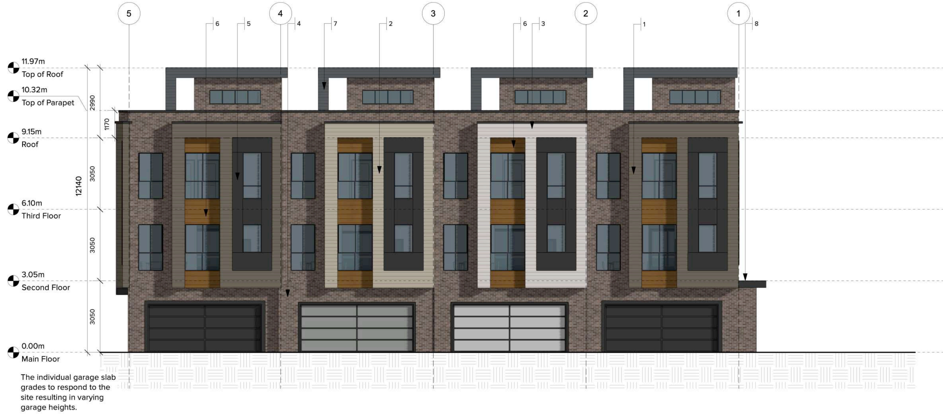
2 EAST ELEVATION - (BUILDING 2) Scale: 1:100
