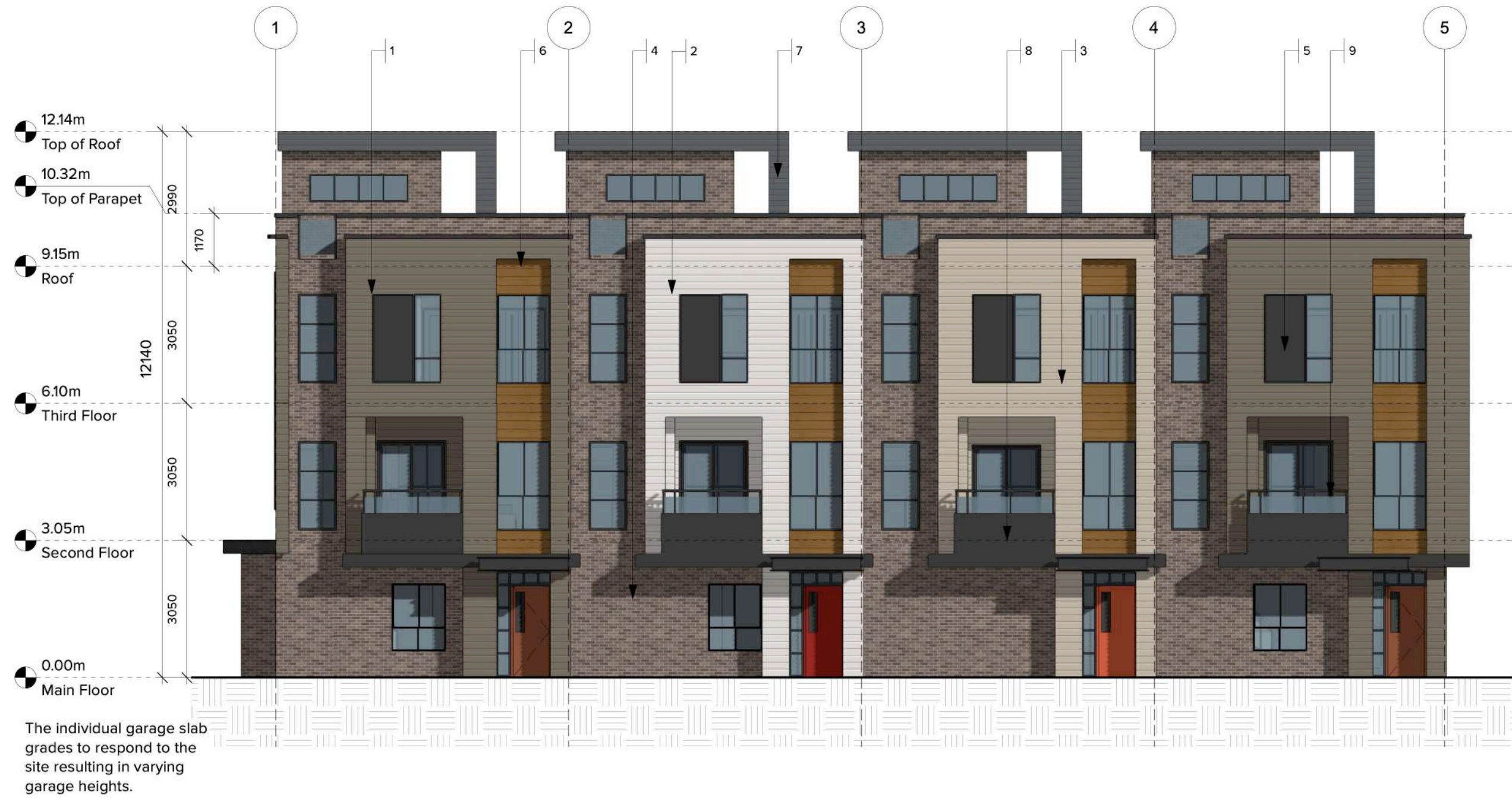
1 WEST ELEVATION - (BUILDING 2) Scale: 1:100
