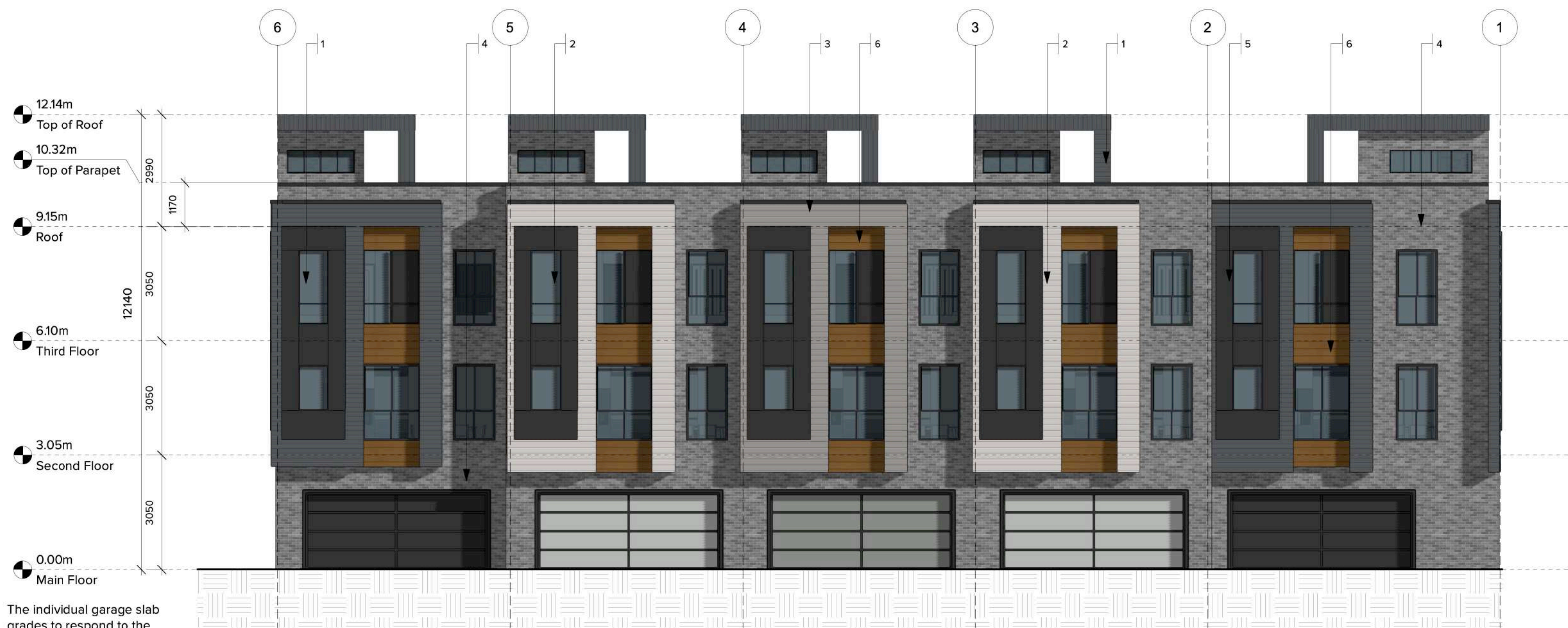
2 EAST ELEVATION - (BUILDING 3) Scale: 1:100
