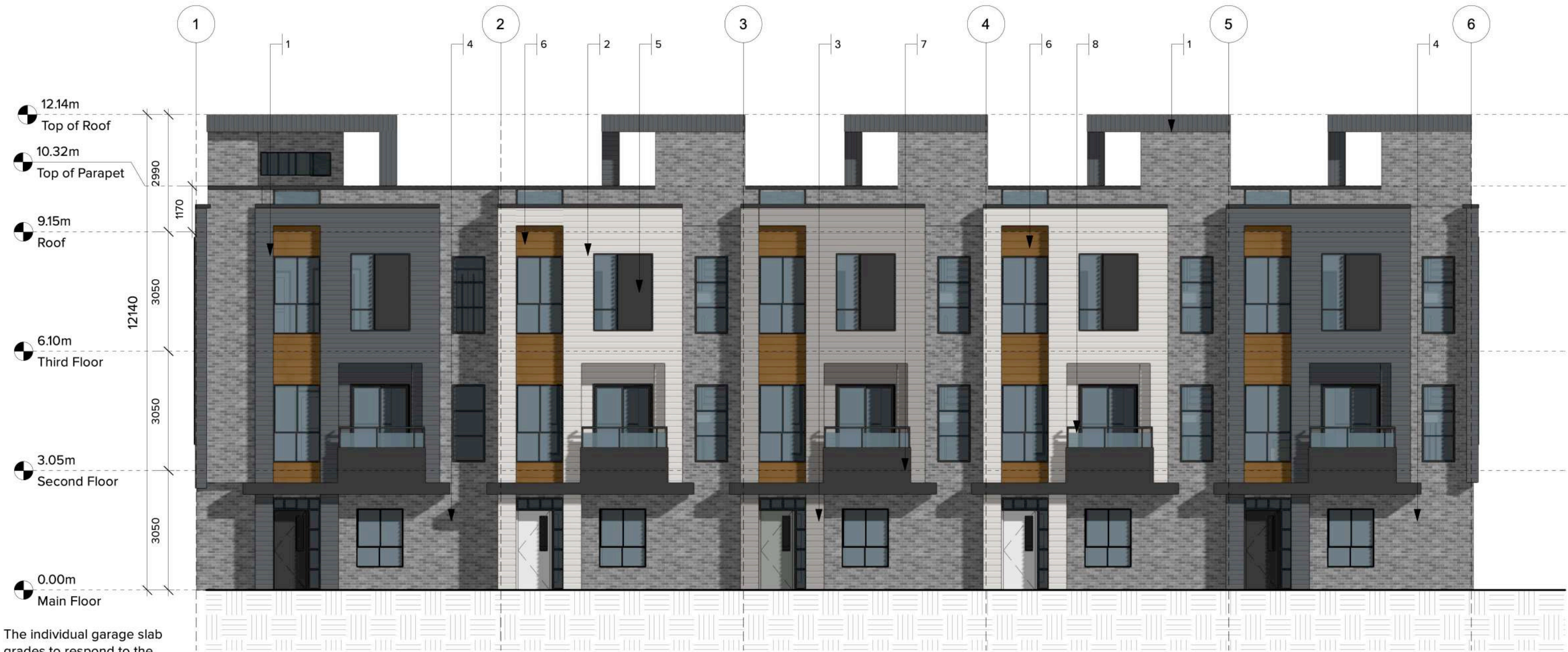
1 WEST ELEVATION - (BUILDING 3) Scale: 1:100
