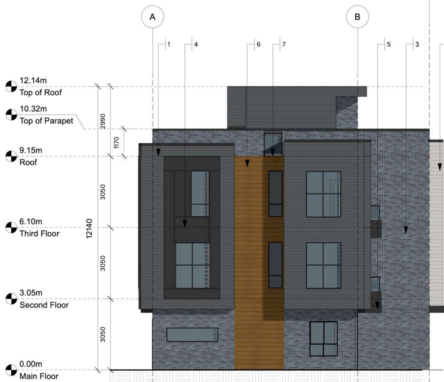
3 EAST ELEVATION - (BUILDING 5) Scale: 1:100
