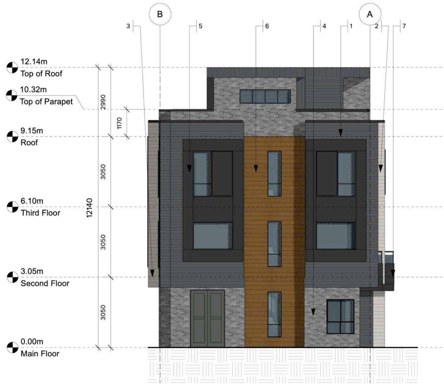
3 NORTH ELEVATION - (BUILDING 3) Scale: 1:100
