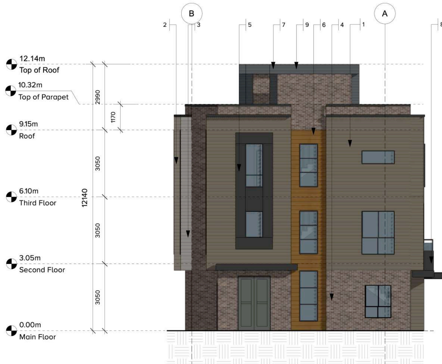
3 NORTH ELEVATION - (BUILDING 2) Scale: 1:100
