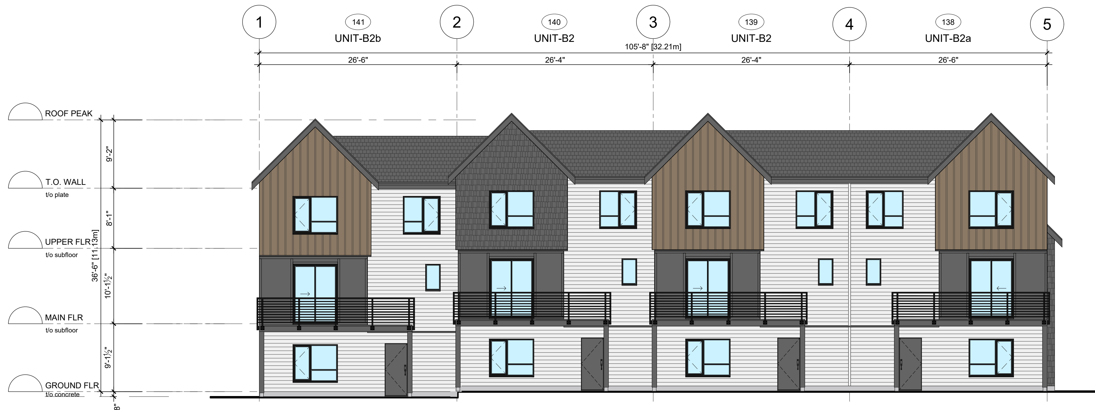
1 FRONT ELEVATION Scale: 1/8" = 1'-0"
