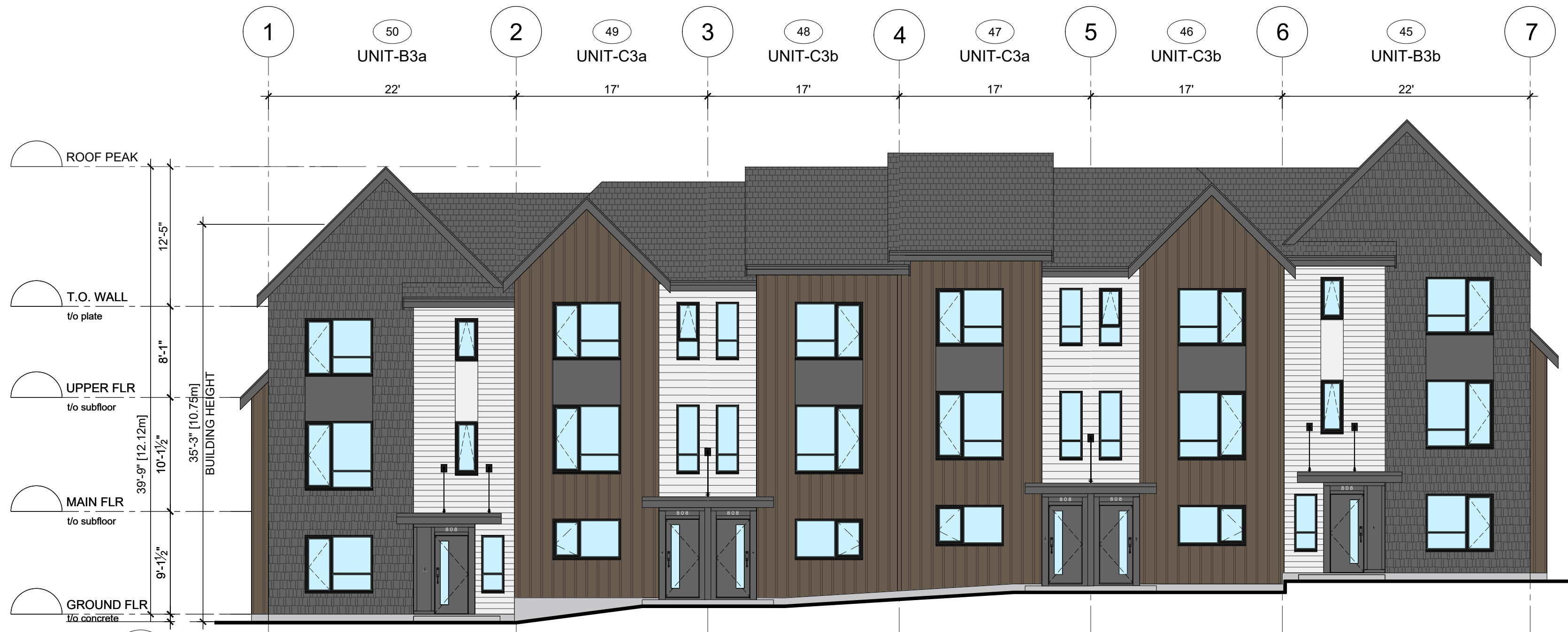
1 FRONT ELEVATION Scale: 1/8" = 1'-0"
